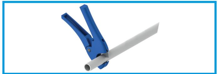
Rohr rechtwinklig und gratfrei abschneiden und sicherstellen, dass das Rohr keine scharfen Kanten, Längsriefen oder sonstige Beschädigungen aufweist. Beim Einsatz von Kunststoffrohren empfehlen wir grundsätzlich den Einsatz von Stützhülsen.
