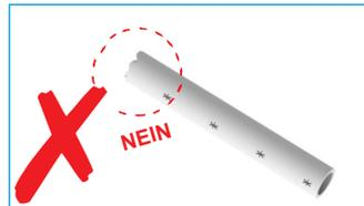
Kein beschädigtes Rohr einsetzen.
