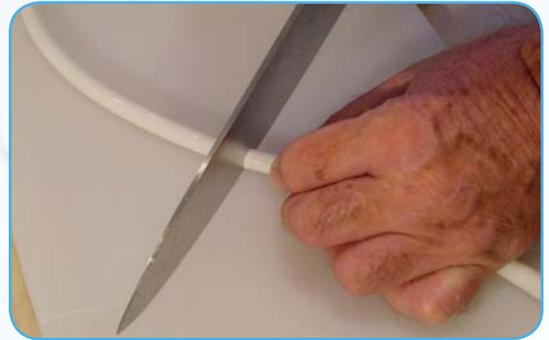
Durchtrennung des Schlauches mit einem scharfen Messer
